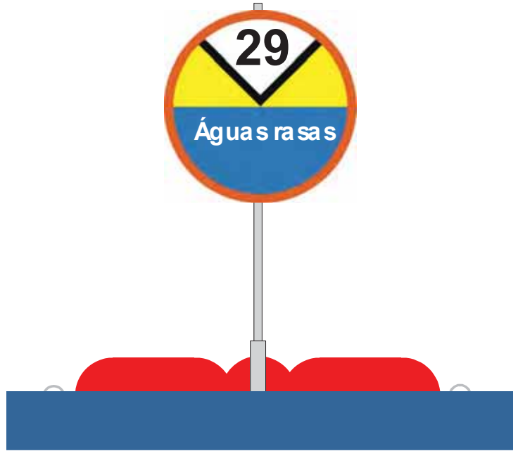
FIGURA 186 – VISTA FRONTAL – CONJUNTO FLUTUANTE COM A PLACA INDICATIVA DE ÁGUAS RASAS
