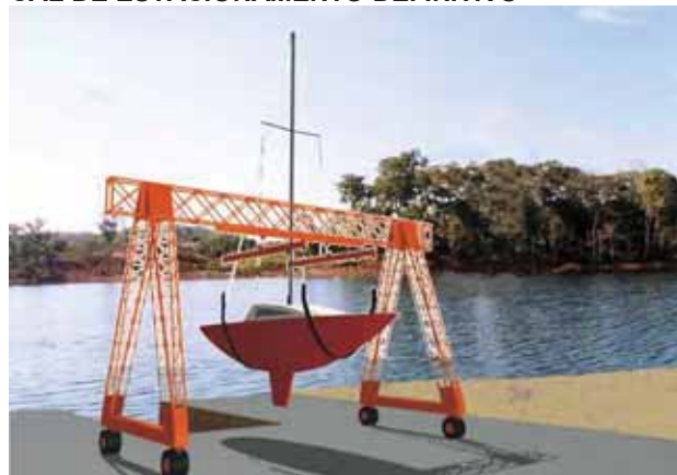
FIGURA 101 – IÇAMENTO DO BARCO, ATRAVÉS DE PÓRTICO, ATÉ A CARRETA QUE O LEVARÁ AO LOCAL DE ESTACIONAMENTO DEFINITIVO
