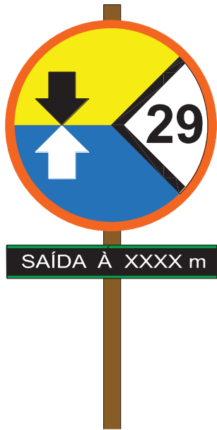
FIGURA 184 – VISTA EXEMPLIFICATIVA COM A P04-D: PLACA DIRECIONAL ÀS SAÍDAS E ACESSOS À DIREITA
