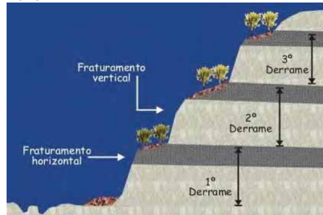
FIGURA 20 – DINÂMICA GEOLÓGICA DOS PAREDÕES
