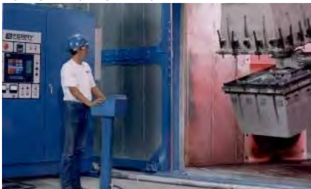
FIGURA 47: DETALHE DA FABRICAÇÃO DE FLUTUADORES DE POLIESTIRENO
