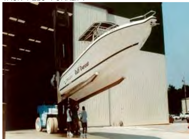
FIGURA 43: E BARCO SENDO RETIRADO DO "DRYSTACK" PELO "FORKLIFT"
