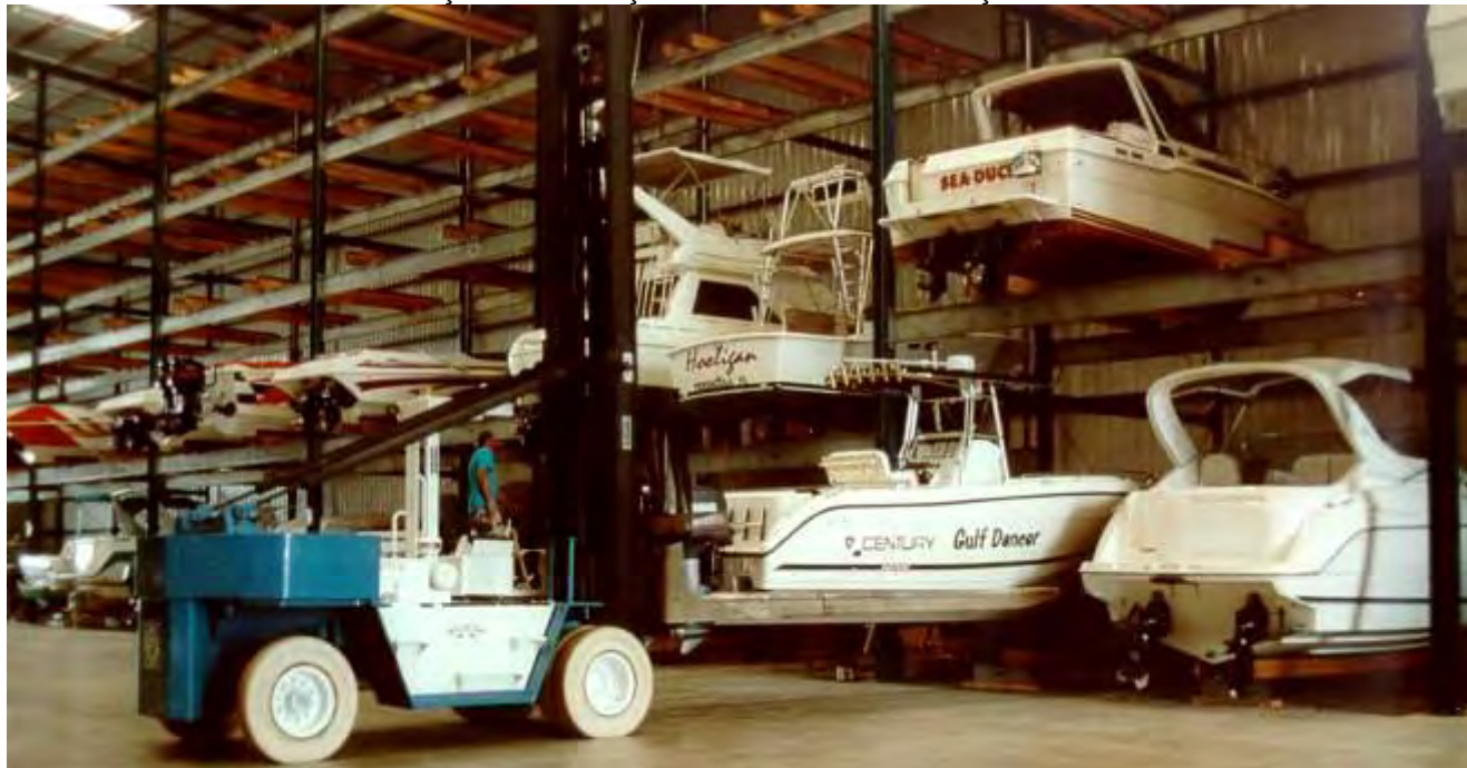
FIGURA 44: "DRYSTACK" OTIMIZAÇÃO DO ESPAÇO E DA OPERACIONALIZAÇÃO
