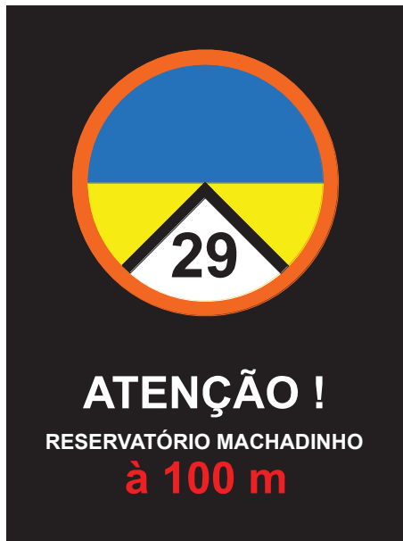
FIGURA 40: P12 - PLACA DE ADVERTÊNCIA I (RESERVATÓRIO À FRENTE)
