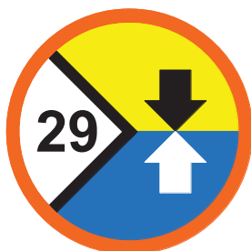
FIGURA 36: P04-D- PLACA DIRECIONAL ÀS SAÍDAS E ACESSOS À DIREITA
